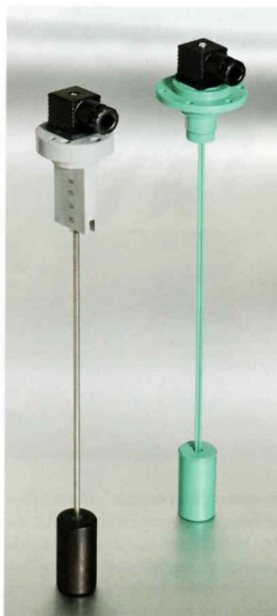
tagliando l'astina in acciaio, con un semplice tagliatubi; in alternativa, è possibile variare il punto di intervento utilizzando un galleggiante con foro passante che permette, ogni qual volta vi sia l'esigenza di modificare il punto di controllo del liquido desiderato. ✓
