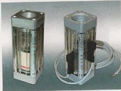
altri. I Flussimetri FLU/P possiedono un'elevata visibilità su ogni lato ed una chiara lettura della scala. Grazie all'originale conformazione del cono, hanno una progressione lineare che pochi riescono ad offrire. Inoltre i Flussostati possono essere dotati di uno o 2 sensori d'allarme a contatto reed, eventualmente integrati da led rosso (verde a richiesta) per una segnalazione in campo della presenza o assenza
