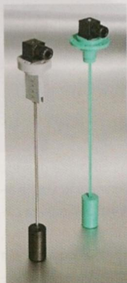
Il livellostato RL-G1 assicura inoltre una sicurezza totale, determinata dal fatto che la parte elettrica è totalmente separata nel lato del serbatoio ed è perfettamente sigillata rispetto al lato esterno, per mezzo della saldatura a ultrasuoni e resinatura dei pin.
