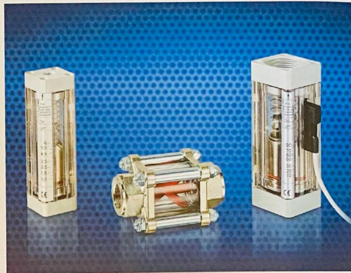
zincato con mozzo esagonale e filettatura interna per il collegamento. Possiedono un'elica reversibile in nylon-vetro e un tubo in vetro Pirex. La temperatura di esercizio è di 90°C con OR in nitrile, adottando quelle in Viton si arriva sino a 130°. Possibilità di elica in alluminio. Gli indicatori di flusso garantiscono precisione e affidabilità per visualizzare e monitorare il passaggio dei fluidi.
